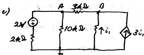
$$\text{d) } \frac{V_A + 2V}{2k\Omega} + \frac{V_A}{10k\Omega} + \frac{V_A - V_B}{3k\Omega} = 0.$$
